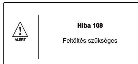
A kazán alatt található feltöltőcsap segítségével a rendszer újratölthetővízzel, így a rendszernyomás helyreállítható.
