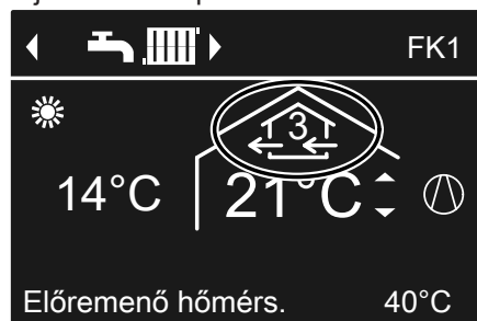
23. ábra Példa szellőztetésre az „Automat. szellőzés” üzemmódban, „Normál” üzemállapotban
